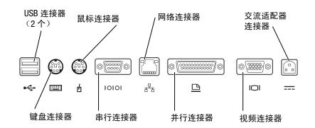
下表列出了 APR 背面的每个连接器的图标,并说明了每个连接器可以连 接的外部设备类型。
