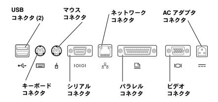
次の表は、APR 背面の各コネクタに対応するアイコンと各コネクタに 接続できる外付けデバイスの種類を示したものです。
